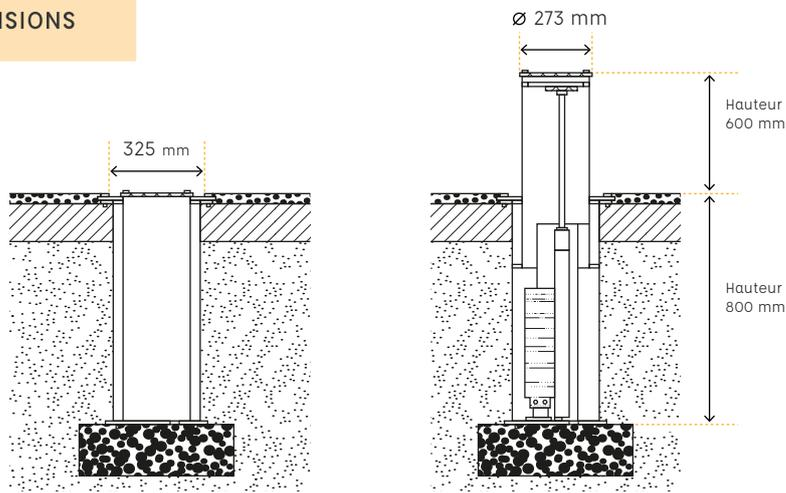
ÉPAISSEURS / Borne mobile : 6mm - Caisson d'encastrement : 4mm
